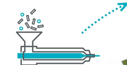
Les granulés sont fondus dans un extrudeur et injectés dans des moules. Nous ajoutons de la couleur au plastique en fusion.
